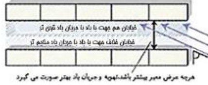
شکل ۱۳- جهت گیری خیابان با زاویه مورب نسبت به جهت وزش باد به منظور جلوگیری از وزش باد مستقیم؛ ماخذ: (milosovicova, 2010: 27)
