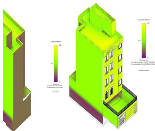
شکل ۴. خروجی تحلیل انرژی ساختمان معمولی
